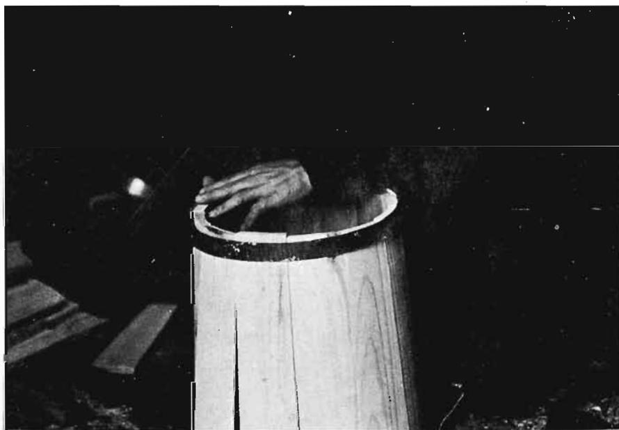
Lámina 13b. Colocación del aro de cabeza durante el armado de un macetero.
