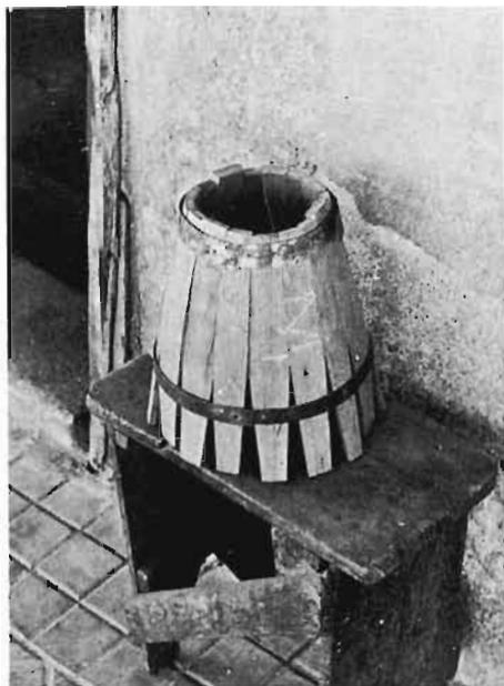
Lámina 13a. Casco de barril con los moldes puestos, antes del eslomado.
