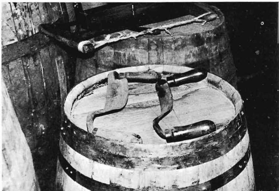
Lámina 3b. *Cuchillas curvas*, taller de L. del Pozo.
