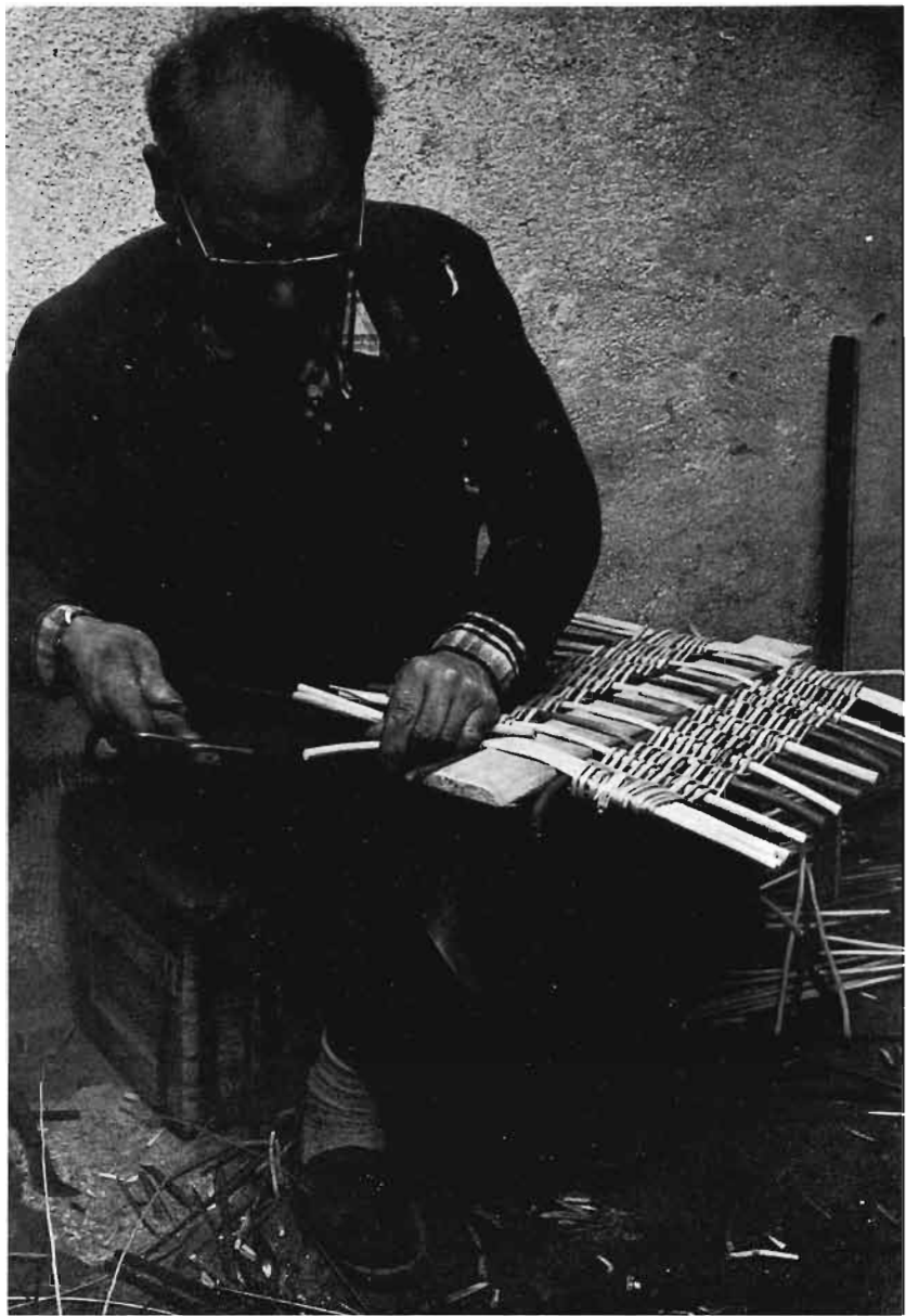
LÁMINA 11.—Clavar las estaquillas en las esquinas para reforzar su tejido.
