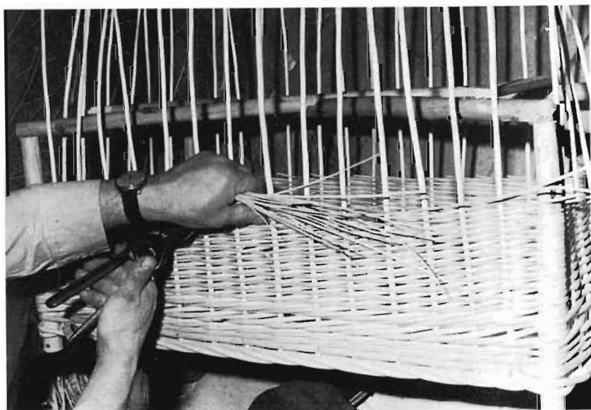
LÁMINA 15 b.—Terminación de la primera mano cortando las puntas sobrantes de las varas.
