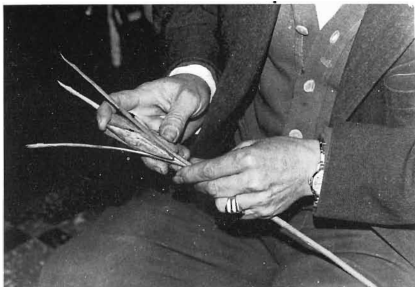
LÁMINA 6.—Utilización de un rajador doble.
