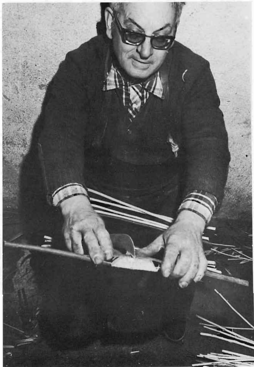
LÁMINA 9 b.—Inserción de una traviesa en el listón de madera que forma el núcleo del fondo ovalado.
