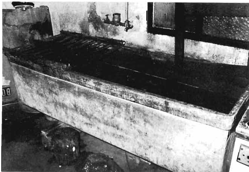
LÁMINA 2.—Pila de uralita con parrilla para el escurrido del mimbre.
