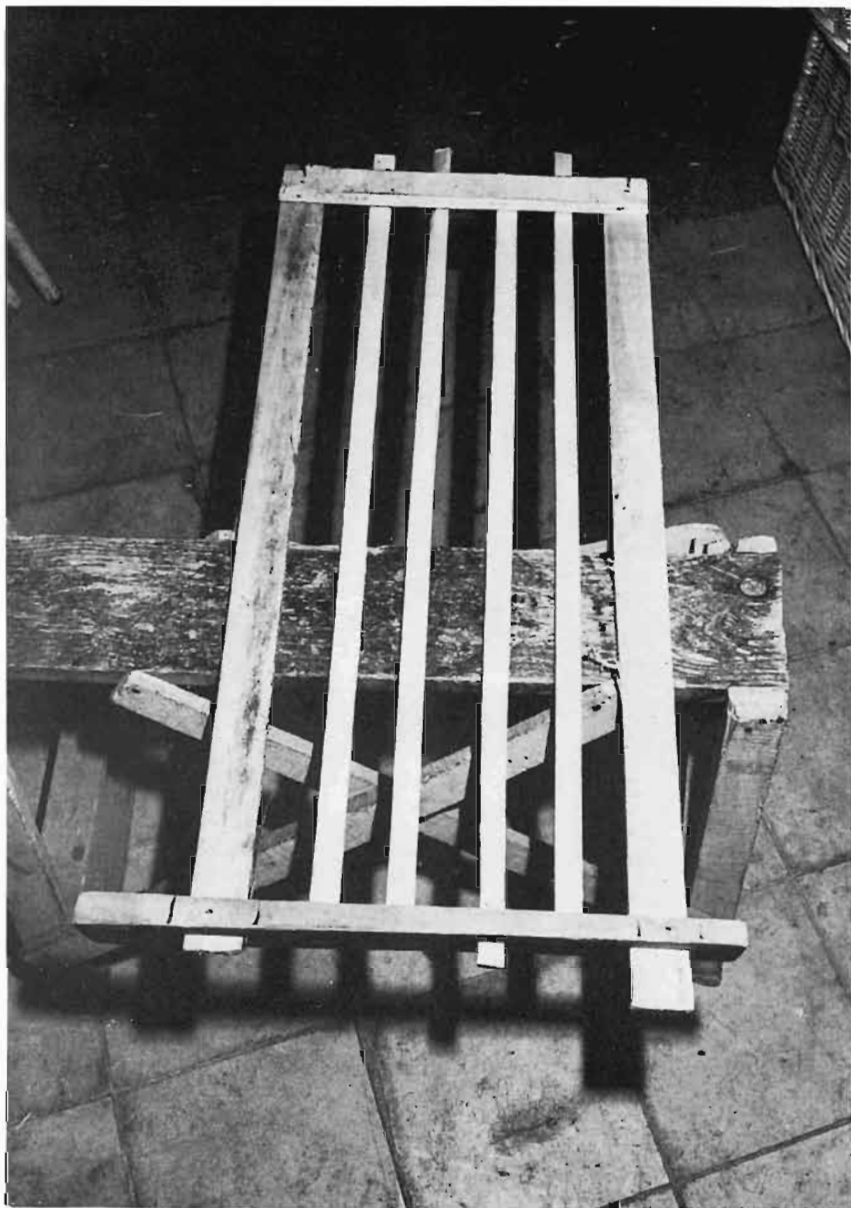
LÁMINA 5.— Esqueleto de un fondo tapa con una barra de sujeción en uno de los extremos.
