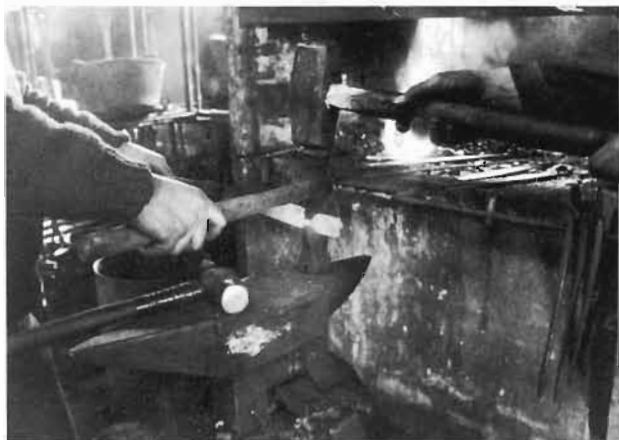
LÁMINA 31 b.—Rebajado curvo por dos lados con el degüello de mano y el yunque.
