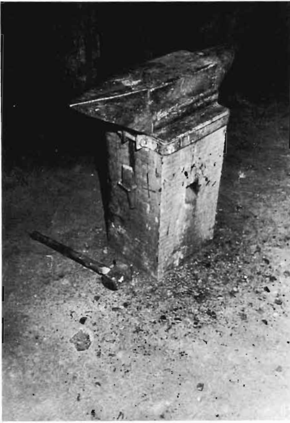
LÁMINA 5 a.—Yunque sobre soporte de mampostería.
