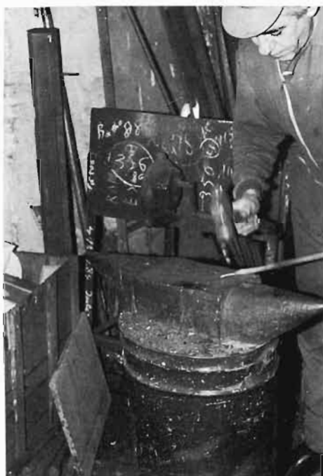
LÁMINA 28. Ensanchando el hierro.
