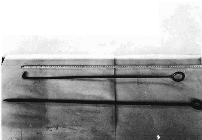
LÁMINA 4 a.—Badiles de fragua: atizador y espetón.
