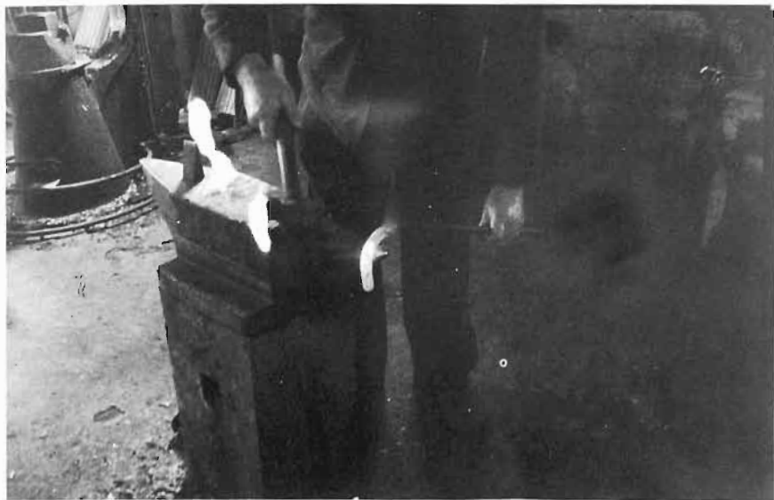
LÁMINA 30.—Curvado del hierro sobre la peña cónica del yunque.
