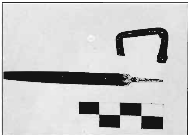
LÁMINA 24.—Lima con aparejo para su sujeción horizontal.
