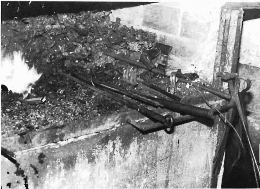
LÁMINA 2.—Barra para sujetar tenazas.
