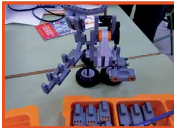
La solución a la práctica ha consistido en el desarrollo de 3 robots trabajando en equipo. El primer robot se encarga de descargar un cargamento de cereales. Una vez el cargamento está recogido, un robot móvil que simula un convoy recorre un trayecto hasta llegar a un almacén. El almacén, al detectar la presencia del convoy, abre las compuertas para dejar pasar el convoy con los cereales.
