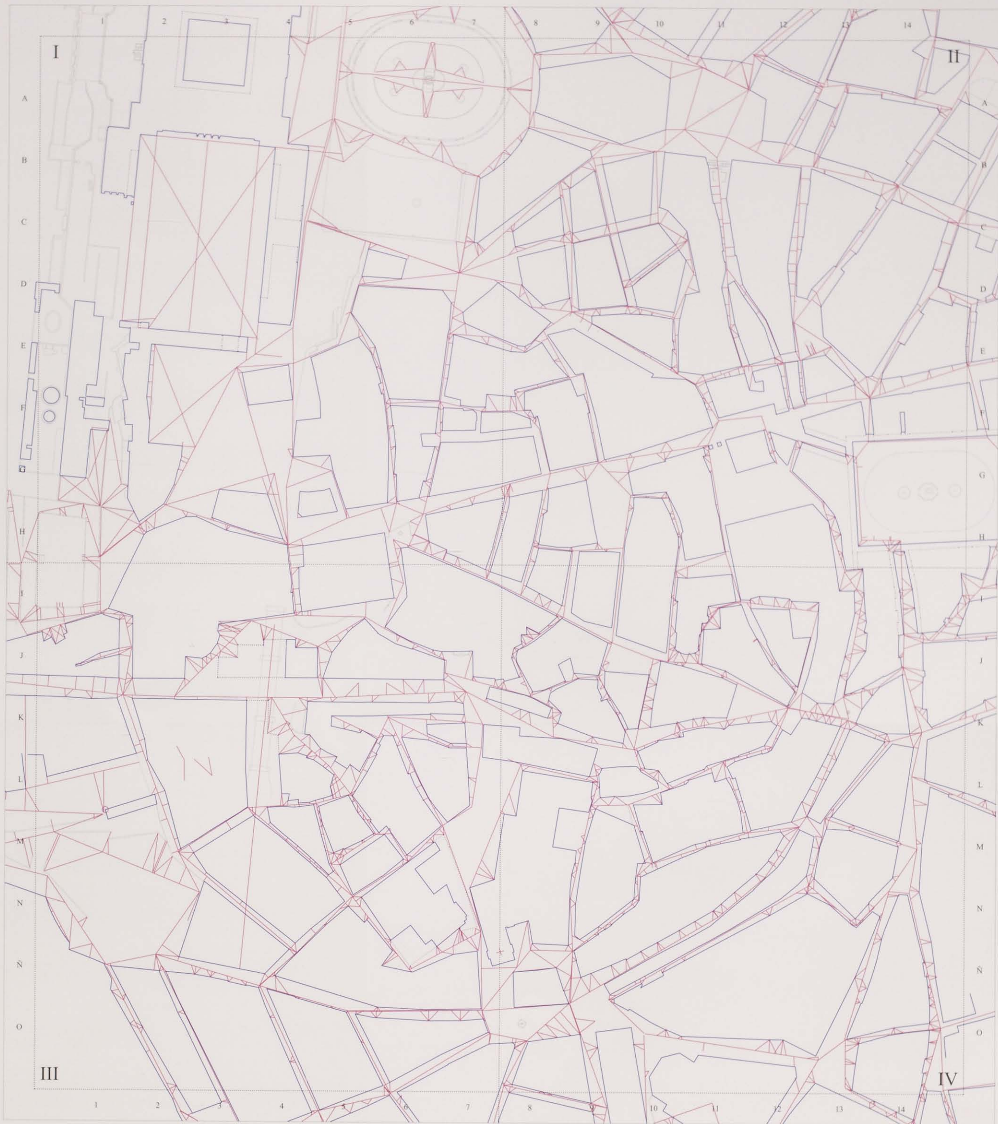
Plano 3. Poligonaciones y referencias a edificios utilizados en los levantamientos de los parcelarios realizados por la Junta Nacional de Estadística entre 1862 y 1870
