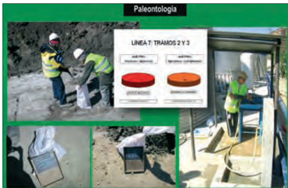
Figura 43. Línea 7 (tramos II, III y IV). Toma y lavado de muestras micropaleontológicas.
