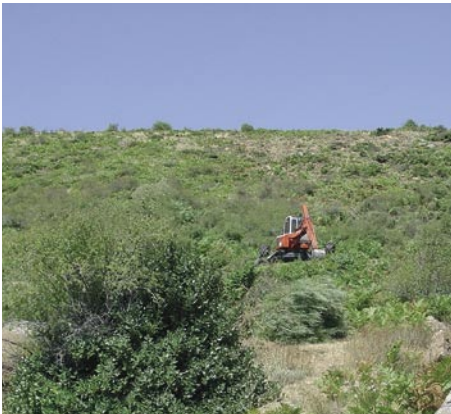
Retroaraña avanzando por una ladera, realizando una labor puntual de ahoyado
