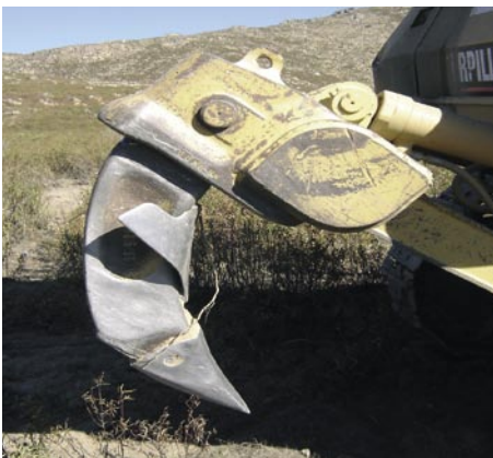
Rejón con aletas soldadas para realizar el desfonde y facilitar el drenaje y el arraigo de la nueva plantación
