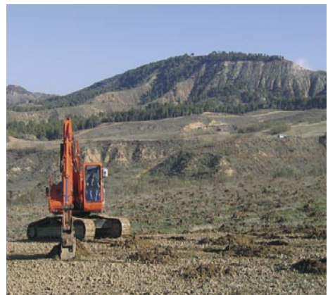
Retroexcavadora giratoria de cadenas realizando una labor de ahoyado
