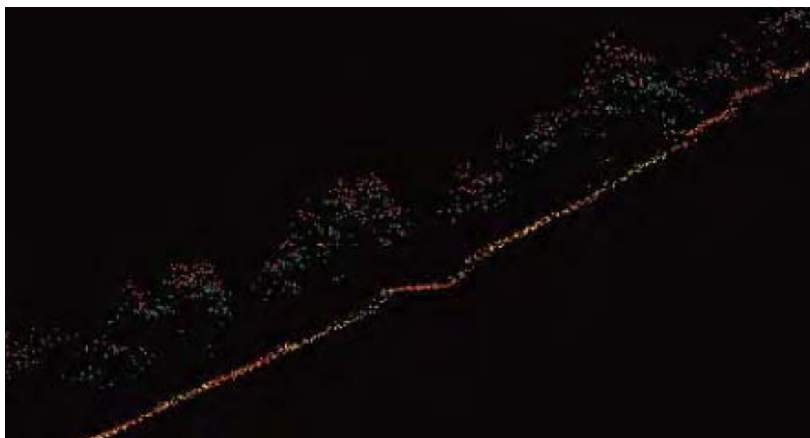
Perfil de la nube de puntos LIDAR clasificada por tipo de retorno (rojo: único, azul: primero, verde: intermedio, amarillo: último)
