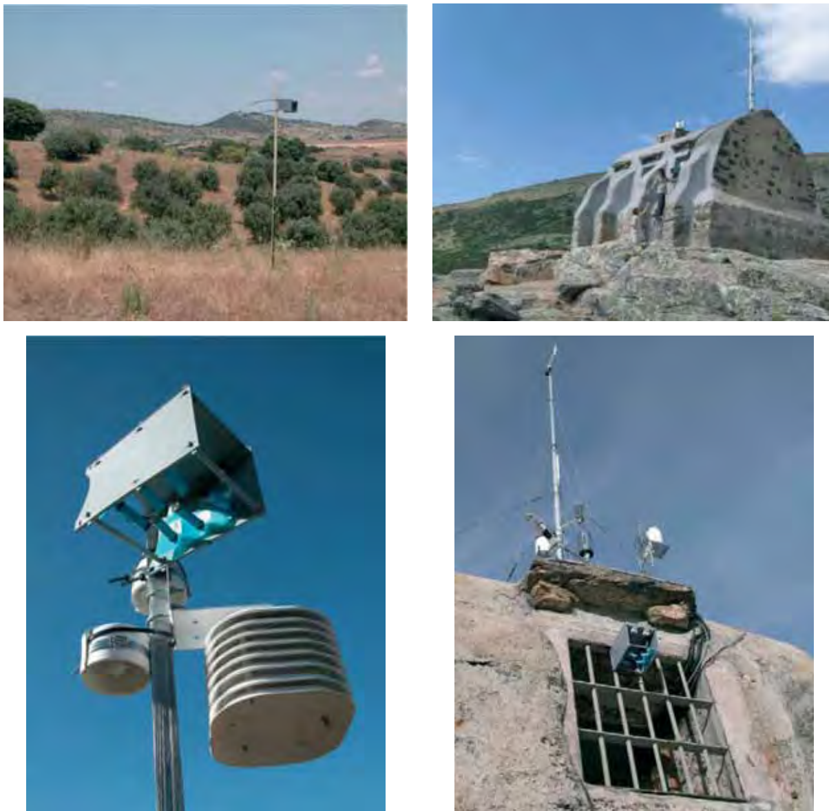
Figura 5. Dosímetros pasivos para la medida de contaminantes atmosféricos y sensores meteorológicos empleados en cada una de las estaciones de muestreo ubicadas a lo largo del gradiente de estudio entre la ciudad de Madrid y la Sierra de Guadarrama. Izquierda-abajo: estación de San Agustín de Guadalix; derecha arriba y abajo: estación de Peñalara (Refugio Zabala).
