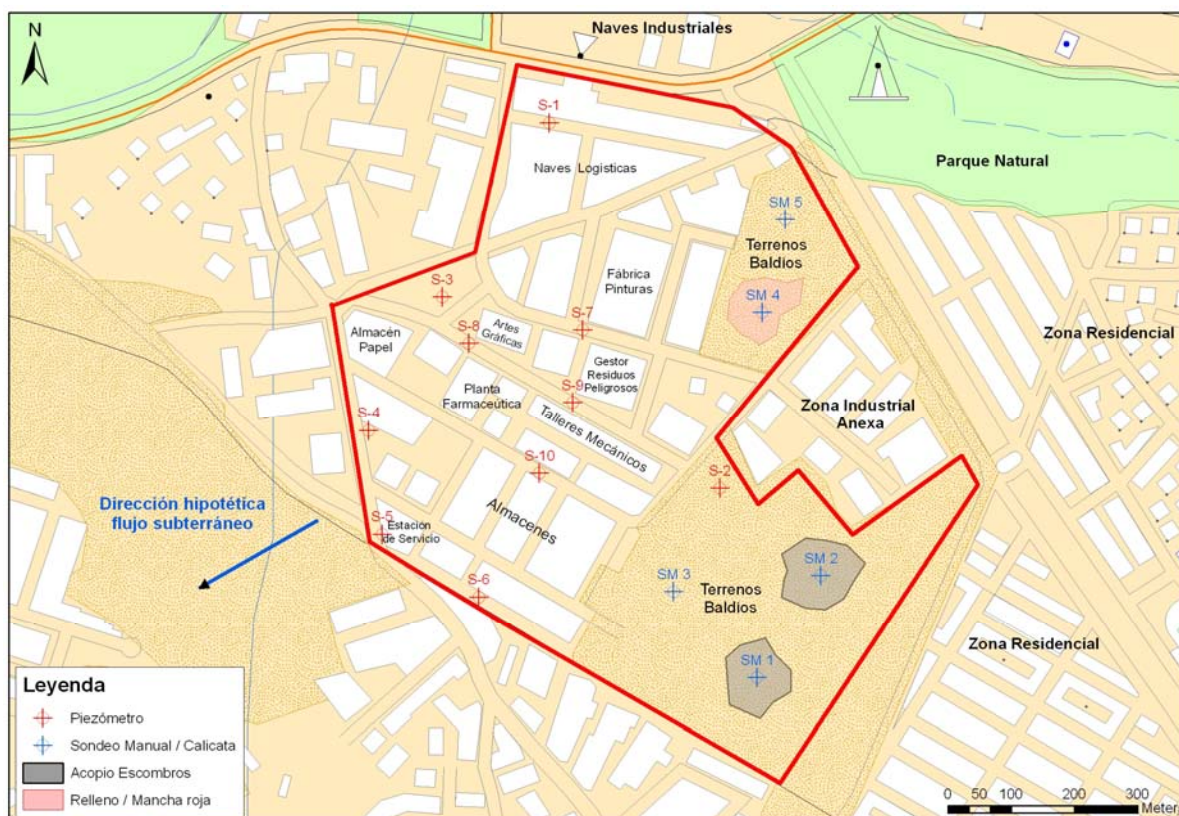
Figura 61. Ejemplo de instalación de piezómetros en un Área Empresarial
