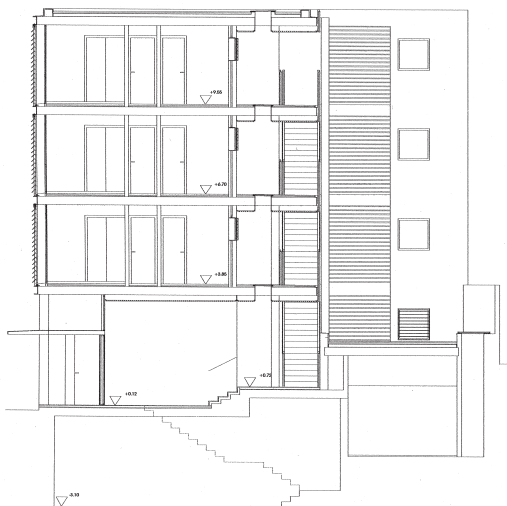
Sección transversal por el patio.
