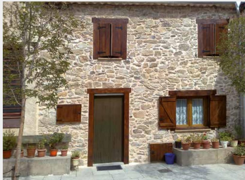
La fachada se ha limpiado y se han retacado con piedras las zonas deterioradas, rejuntando posteriormente toda ella con mortero de cemento y con aditivos hidrofugantes y minerales de color. Los dinteles y jambas de ladrillo se han sustituido por otros de madera, cambiando también los vierteaguas por otros de piedra natural.
