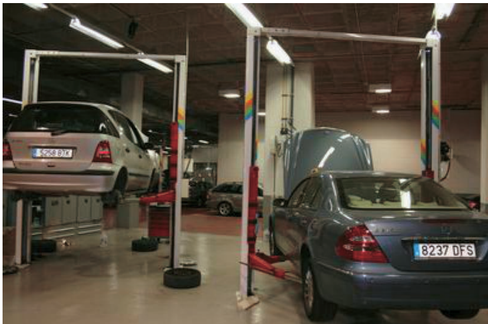
Figura 1. Elevadores taller mecánico-eléctrico.
