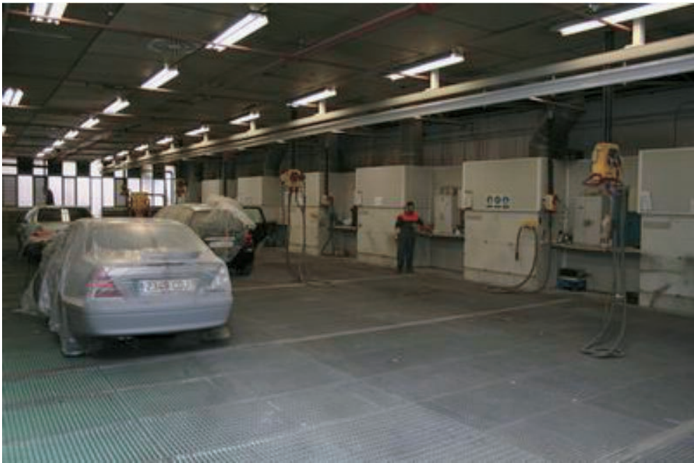
Figura 3. Detalle zona aspiración taller de chapa-pintura.
