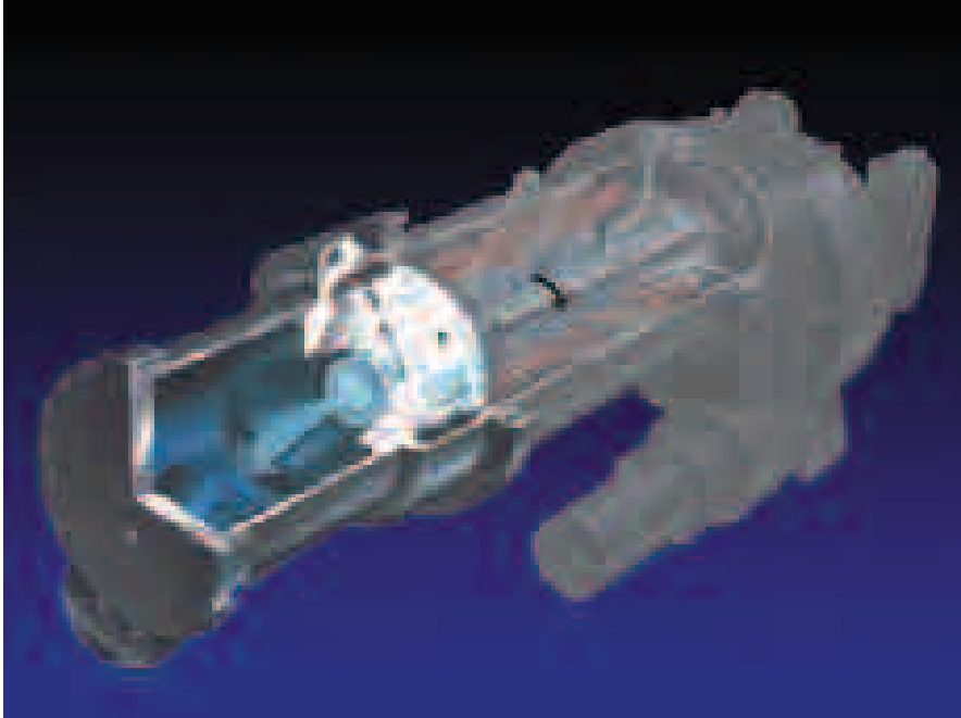
Figura 6. Turbina de expansión en unidades centrífugas.
