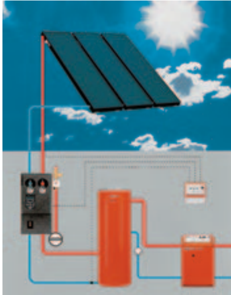
Figura 1. Componentes de una instalación solar.
