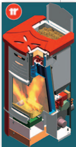
Figura 30: Esquema de caldera de pellets de 25 kW.
