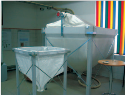
Figura 15: Silos de polipropileno para pellets (capacidad de 2 a 5 toneladas).
