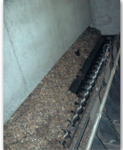
Figura 26: Sistema de alimentación mediante tornillo sinfin.
