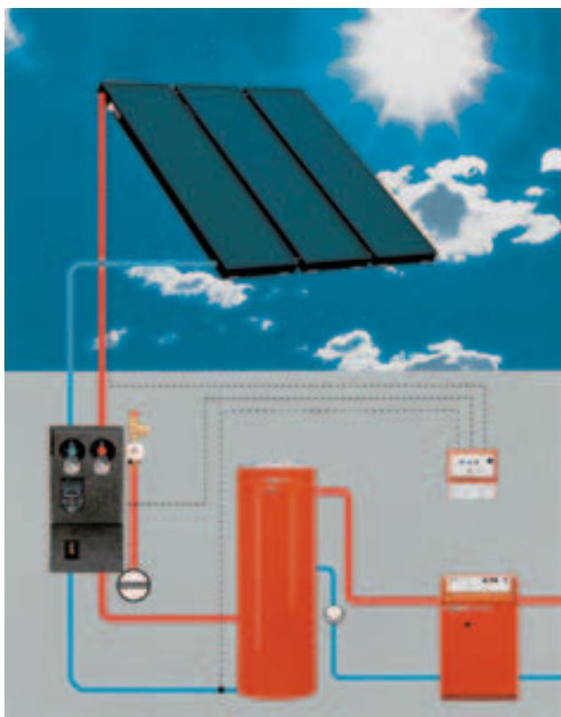
**Figura 1.** Componentes de una instalación solar.
