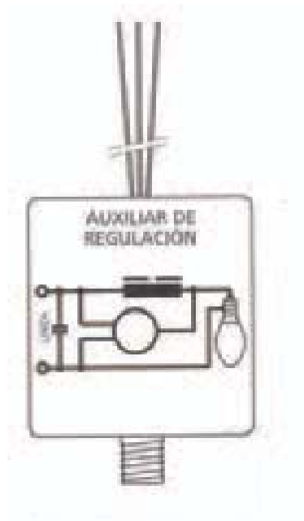
Figura 4 Auxiliar de regulación.
