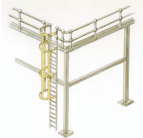
Escaleras permanentes verticales fijas (Escalas).
