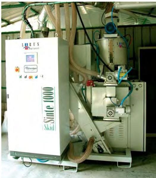
Peletizadora compacta con capacidad de producción de 100 kg/h. Consumo 0,13 kWh/kg de pelets.
