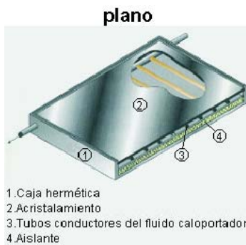
Figura 14. Esquema de captador plano.
