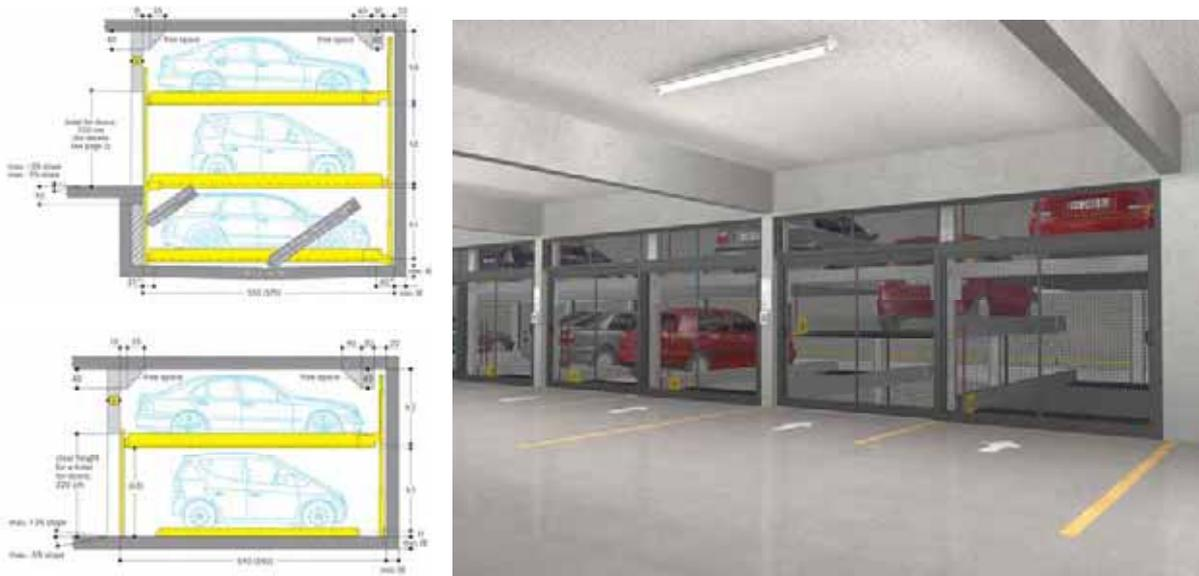
**Figura 6.** Esquemas y vista del sistema *Combilift*.
