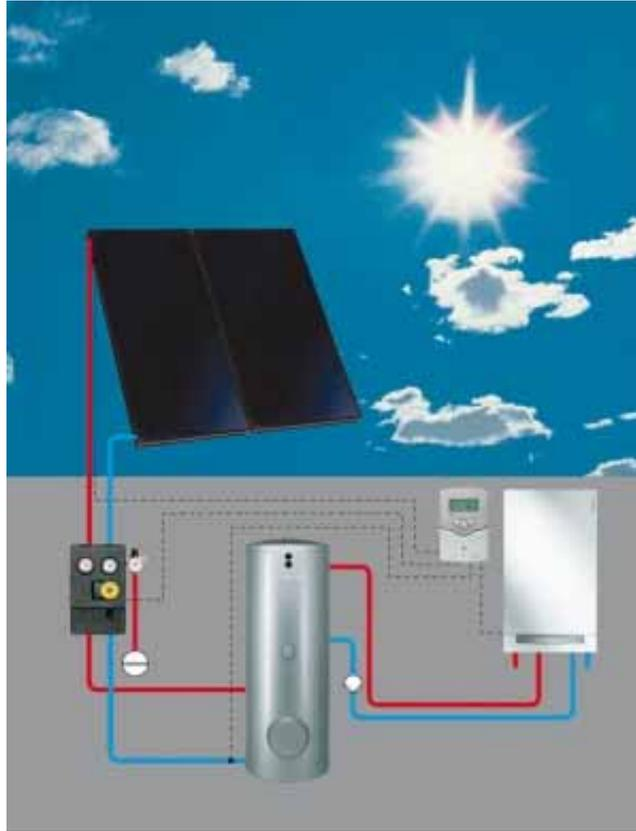
Figura 1. Componentes de una instalación solar.
