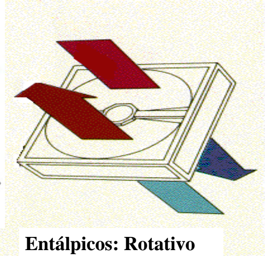
Figura 6. Tipos de intercambiadores recuperadores de calor.
