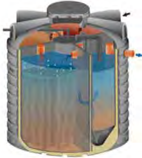
Figura 4. Reactor SBR Istobal. Semisección.
