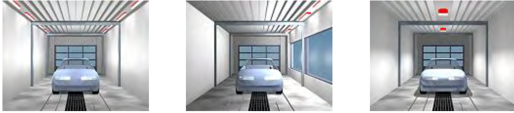
Figura 8. Iluminación en túnel de lavado.
