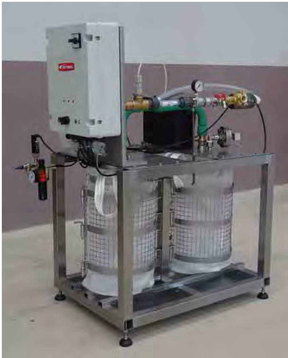
Foto 7. Deshidratador de lodos.
