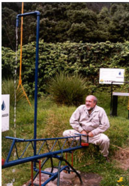
Foto 34. Bomba de extracción de aguas en la Comunidad Las Gaviotas, Colombia (Fuente: Fundación Zeri).
