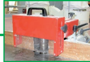
Protecciones de la fresa en la zona de operación
