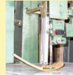
Protección zona de corte
