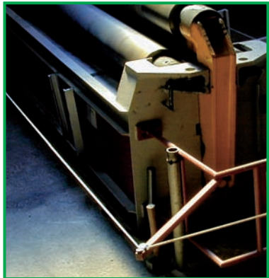
Cable de parada de emergencia perimetral
