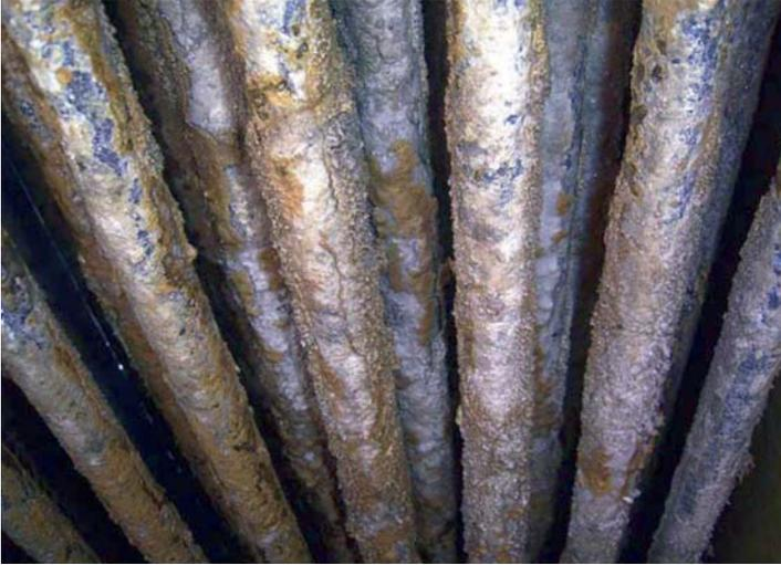
**Depósito de incrustaciones en la batería de tubos de un condensador evaporativo.**
