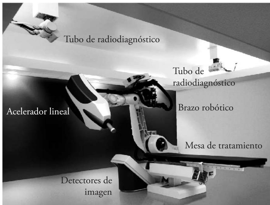
El brazo robótico es controlado por ordenador y tiene 6 grados de libertad, posicionando al LINAC sobre el paciente en más de 100 posiciones. Los tubos de radiodiagnóstico acoplados a los detectores de imágenes de rayos x determinan la posición del acelerador lineal sin la necesidad de marco estereotáxico. Para la localización de la lesión utiliza como sistema de referencia puntos radiográficos internos como la estructura ósea o marcadores radio-opacos implantados cerca de la lesión.
