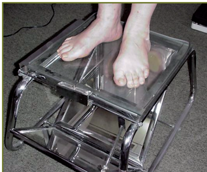
Podoscopio clásico para la observación de las formas del apoyo plantar. Imagen-espejo, construcción de aluminio y espejo en ángulo de 45°.
