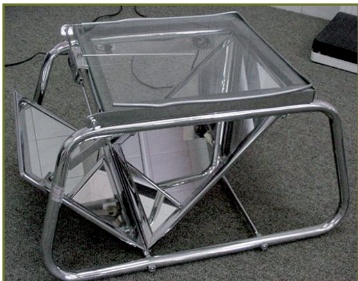
Podoscopio clásico para la observación de las formas del apoyo plantar. Imagen-espejo, construcción de aluminio y espejo en ángulo de 45°.
