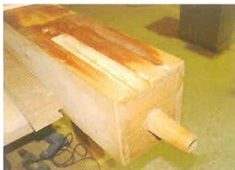
Proceso de reparación de una grieta en un tubo del Subbajo 16'. (Santiago Orta)
