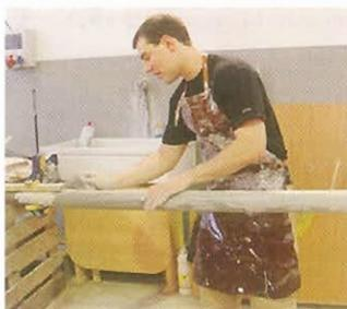
Proceso en el que, tras retirar la suciedad adherida a la superficie del tubo, se aplica una solución específica para su limpieza y posterior pulido. (Santiago Orta)
