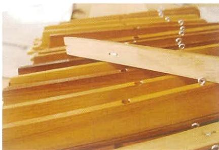
Nuevas ventillas o válvulas para la mecánica. (Santiago Orta)
