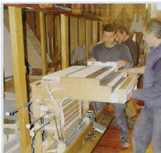
Proceso de colocación de la consola mecánica con sus acoplamientos y demás mecanismos en su emplazamiento original. (Santiago Orta)
