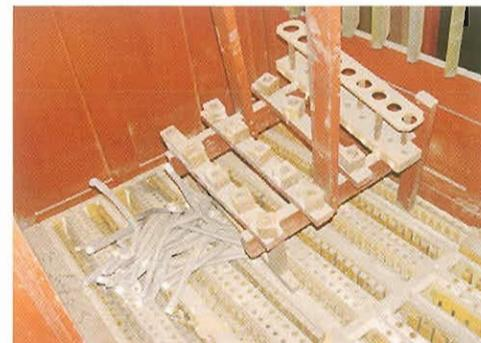
Pasillo detrás de las cajas expresivas con dos hileras de tubería correspondiente al pedal. (Santiago Orta).
