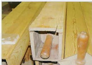
Detalle en el que se aprecia la deformación de la madera agrietada y descolada en el extremo de un tubo de madera por la acción de la sequedad y el calor. (Santiago Orta)
