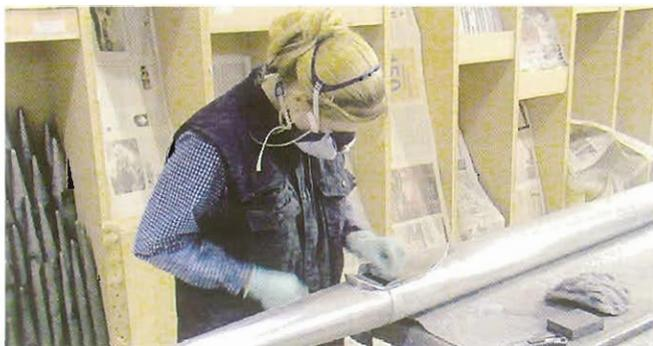
Proceso de pulido a mano de la tubería, una vez retirado el producto aplicado para su limpieza. (Santiago Orta)
