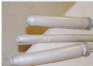
Detalle de abolladuras y pliegues de la tubería de metal antes de su restauración ocasionadas por soportar su propio peso. (Santiago Orta)
