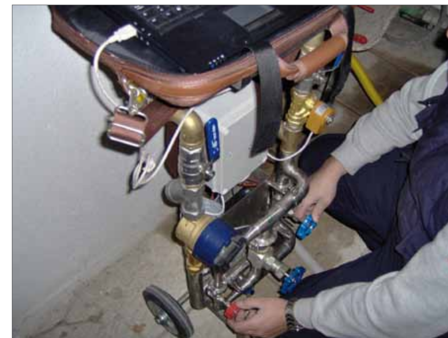
Figura 20. Ajuste del caudal durante la realización de un ensayo en campo
