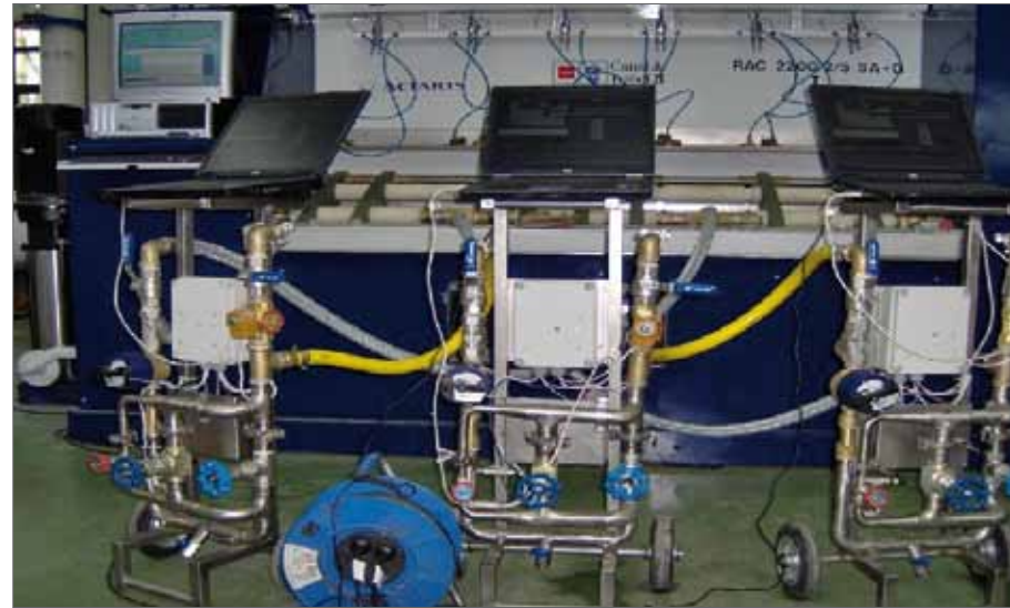
Figura 12. Verificación en laboratorio de los equipos portátiles de verificación en campo
