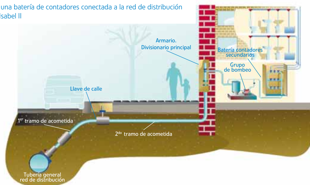
Figura 53. Batería de contadores secundarios divisionarios y contador divisionario principal ubicado en armario
