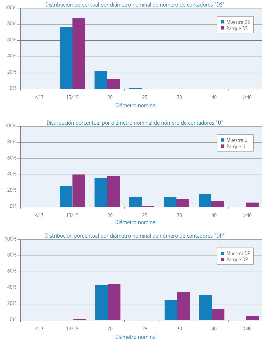
Figura 58. Comparación entre el porcentaje de contadores divisionarios secundarios, únicos y divisionarios principales, por diámetros nominales, en el parque (2006) y en la muestra analizada
