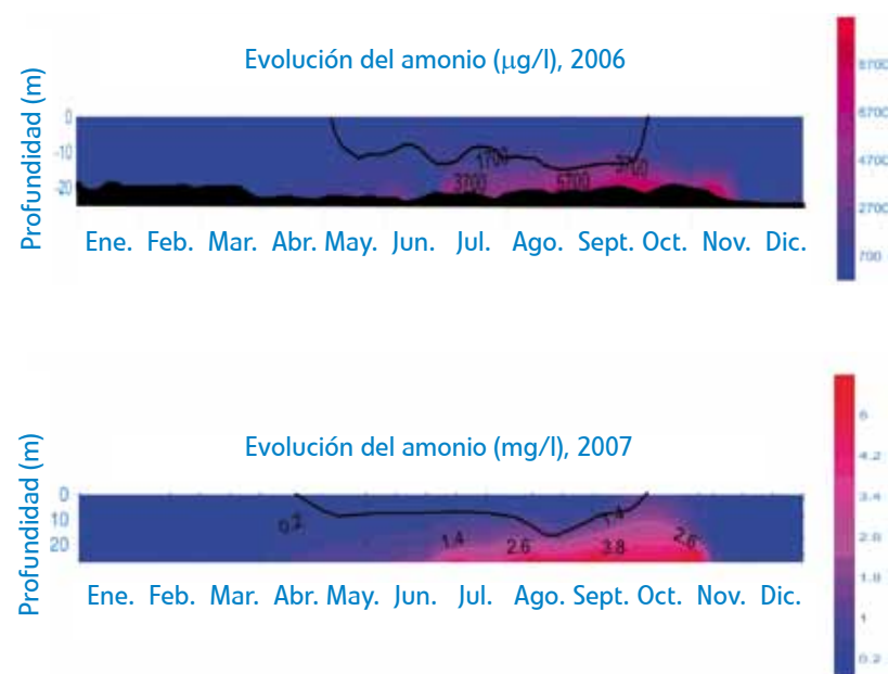
Figuras 112 y 113. Evolución del amonio en el embalse de Santillana, durante 2006 y 2007
