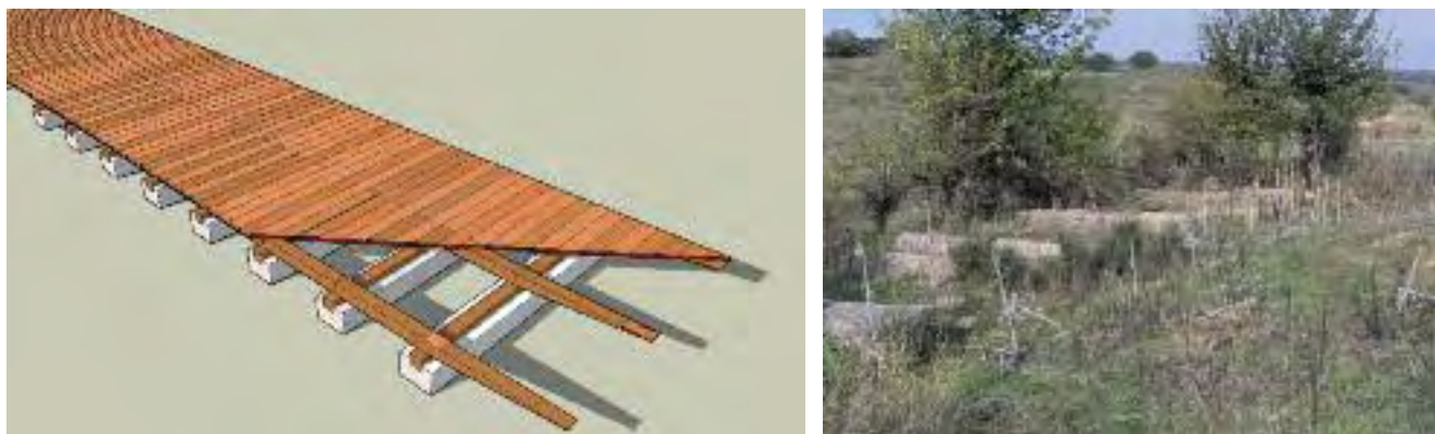
Fig. 84 a- b.- Hipótesis de reconstrucción de la pasarela sobre el arroyo Quijorna elaborada a partir de los testimonios orales y los restos conservados. Toda la madera fue retirada para reconstruir el pueblo en la posguerra. Dibujo: Pablo Schnell. Fotografía: Rubén de la Mata.
