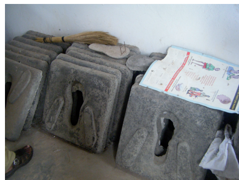
Foto 10.3. Fabricación local de losas "sanplat" para saneamiento mejorado de bajo coste. Gombero, Tanzania, 2010.
