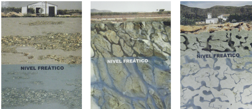
Figura 9.1 De izquierda a derecha representación de un acuífero detrítico, un acuífero fracturado y un acuífero karstificado.
