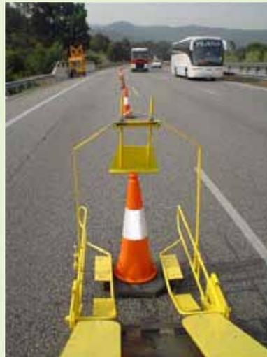
Fabricada en aluminio, consta de una **cinta transportadora de caucho con funcionamiento reversible** (en función de si se están realizando trabajos de colocación o de recogida), que trabaja a través de un motor alimentado a 12v.
