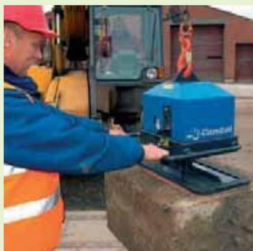
En el caso de equipos con alimentación mediante baterías, en los que el equipo esté sostenido por una máquina, el acople a la misma se puede hacer mediante una **cuerda o cadena con resistencia contrastada para el peso a soportar**.
