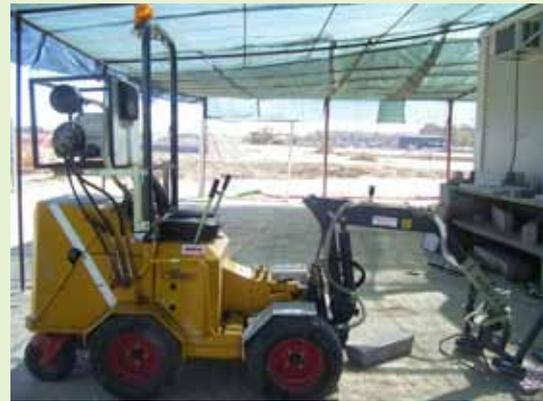
*Máquina de manejo de cargas (losetas) por succión*
