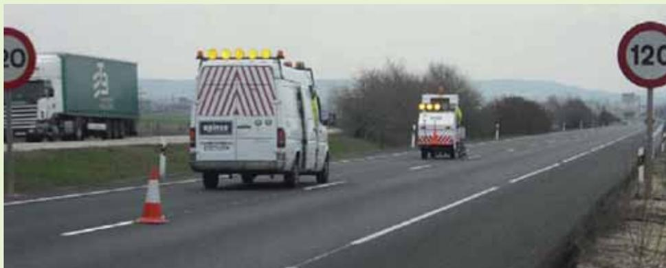
El dispositivo, que se adapta a un vehículo de señalización, permite la colocación y retirada de conos, dando una gran agilidad sobre todo en tramos largos y cortes de emergencia.
