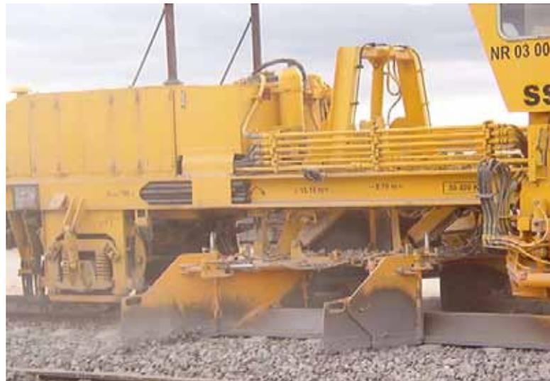
Seguidamente, y después del último bateo, se realizarán **los trabajos de estabilización dinámica controlada** como tratamiento final antes de la puesta en servicio de la vía.
