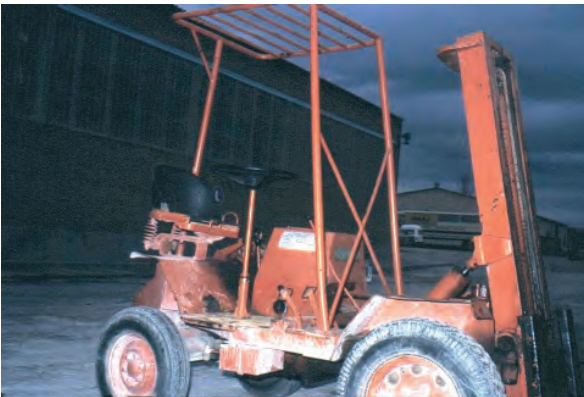
Figura 13. Asiento, de carretilla elevadora, con muelles.
