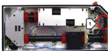
FIG. 7 Interruptor de interbloqueo del cabezal láser (parte óptica)
