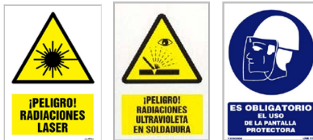
Señales de seguridad de peligro y uso obligatorio EPI
