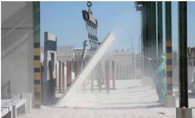
FIGURA 35 - EQUIPO PARA PULIDO DE PREFABRICADO
