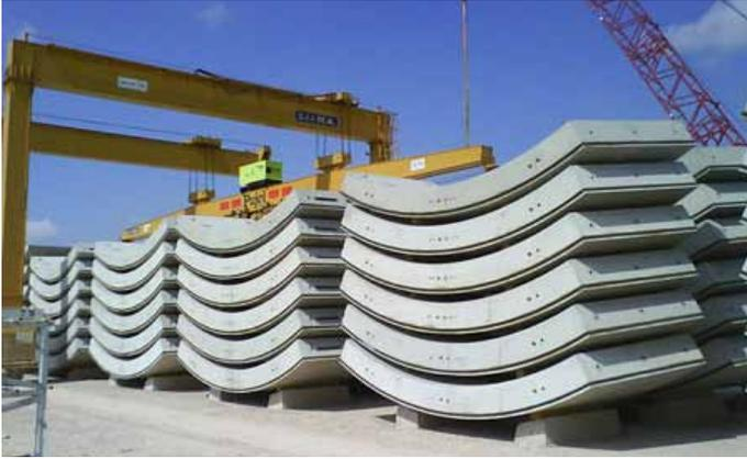
Para realizar el **movimiento de la pieza** desde la zona de fabricación hasta la de almacenamiento, y en función de las instalaciones existentes en la planta y de las propias características de la pieza, se suelen utilizar **vagones de transporte** o bien **puentes grúa**.
