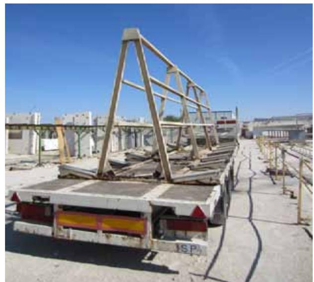
En el caso de las **operaciones de carga**, los operarios acceden a las piezas para su enganche (y fijación de medios de guiado) mediante la utilización de un medio auxiliar (normalmente escaleras manuales). Es este el punto crítico, ya que se dan situaciones en las que el **medio auxiliar utilizado no es el correcto por la altura a la que se debe acceder, o bien está en malas condiciones**; por lo que se producen accidentes por **caída en altura del operario**.
