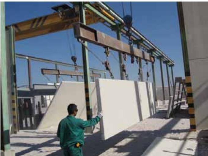
Posteriormente, y ya en la zona de almacenamiento propiamente dicha, se procede normalmente a la manipulación y depósito de las piezas mediante puentes grúa, los cuales también se usan para su colocación y carga en los medios de transporte utilizados para su envío a obra.
