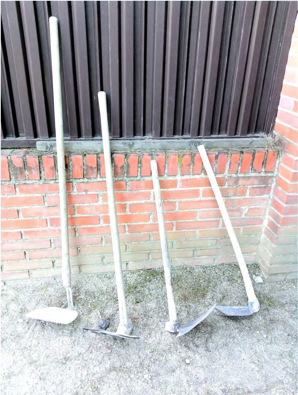
Fig. 7: Herramientas manuales empleadas para labores de limpieza y desatranco.
