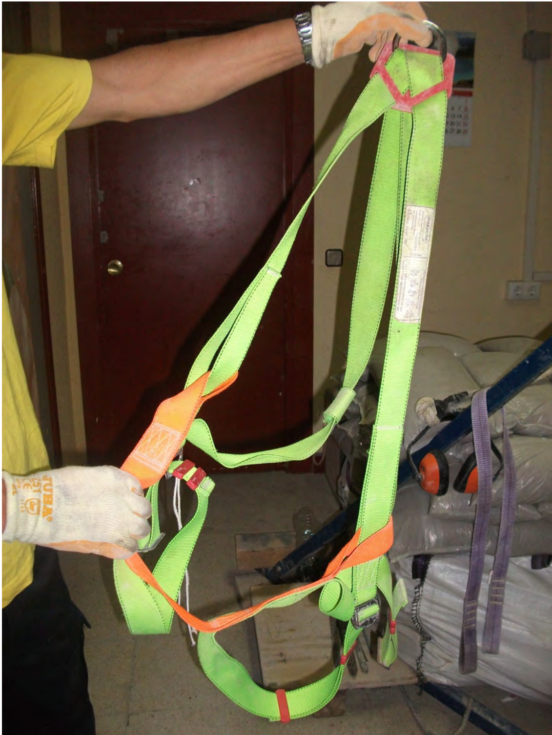
Fig. 42: Arnés de seguridad empleado para acceder al interior de una galería en mina, a través de un pozo.
