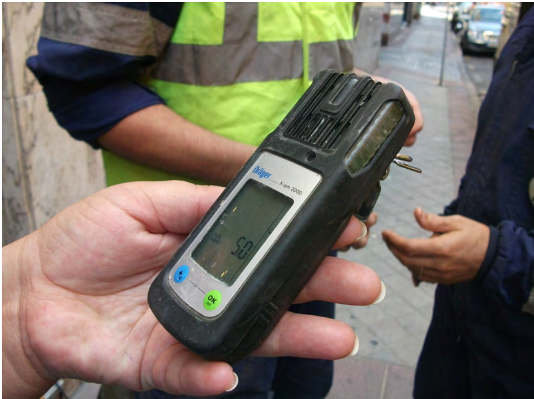
Fig. 17: Medidor de concentración de gases para valorar la calidad del aire.
