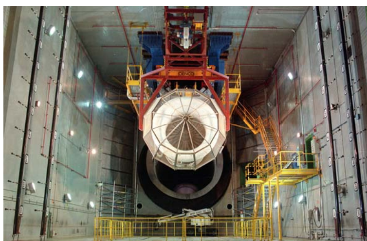
Figura 2.16. Banco de ensayo y desarrollos de motores de reacción del INTA.
