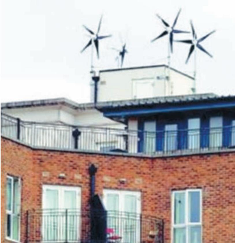
**Figura 4.9.** Imagen de una implantación de energía mini eólica en el tejado de una vivienda.
