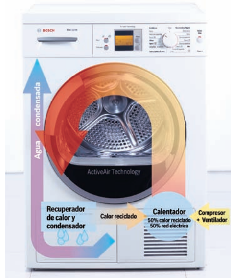
Figura 12. Calentamiento por bomba de calor.
