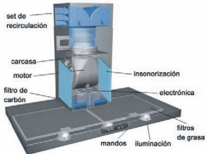
Figura 19. Componentes de una campana.
