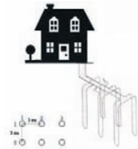
Figura 9. Esquema de configuración en "boreholes". Fuente (GEOCOOL).
