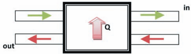
Figura 5. Recuperador de calor.
