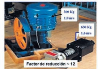
Figura 10. Máquinas convencionales para cables trenzados de acero y de tracción directa para otros medios
