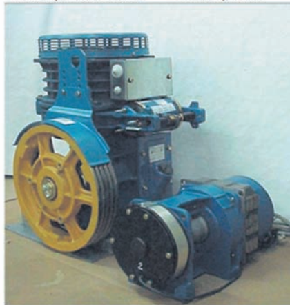
Máquina tradicional (con reductora de engranajes) Tracción por cable de acero Máquina Gearless (sin reductora de engranajes) Tracción por cinta
