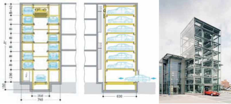
Figura 3. Secciones y vista de un sistema Parksafe.
