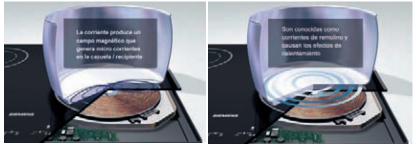
Figura 16. Campo magnético y corrientes de Eddy o Foucault.
