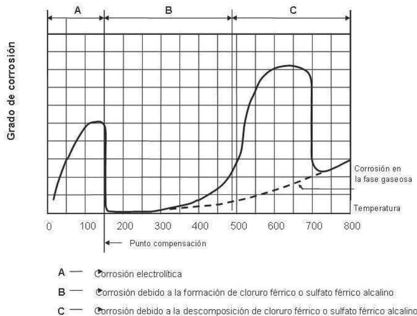
**Figura 3.7.** Grado de corrosión en función de la temperatura de la pared metálica del tubo.
