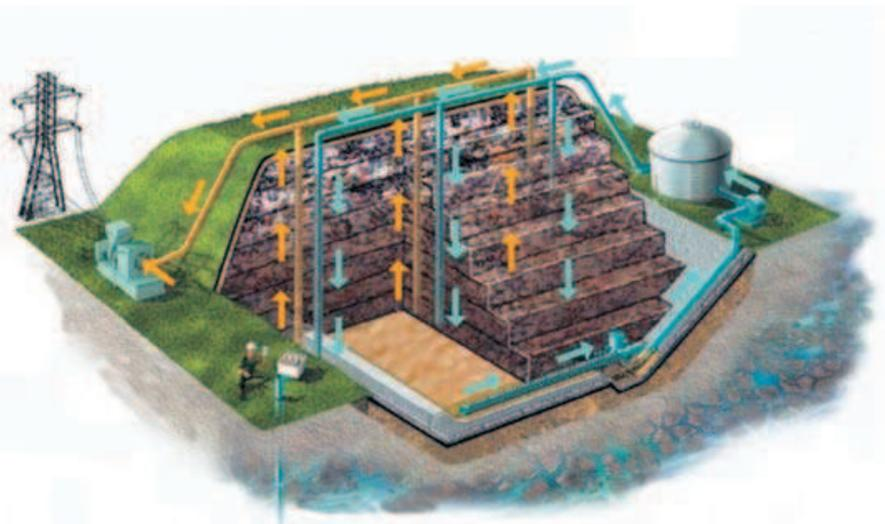
**Figura 2.5.** Esquema de un Biorreactor Activable en celdas de vertedero.
