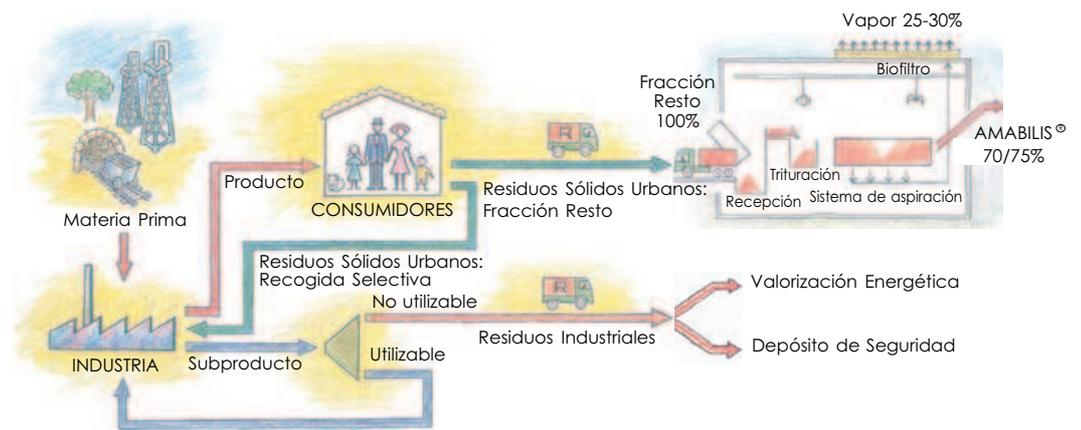
**Figura 2.1.** Esquema de generación de residuos. (Fuente: ECODECO).
