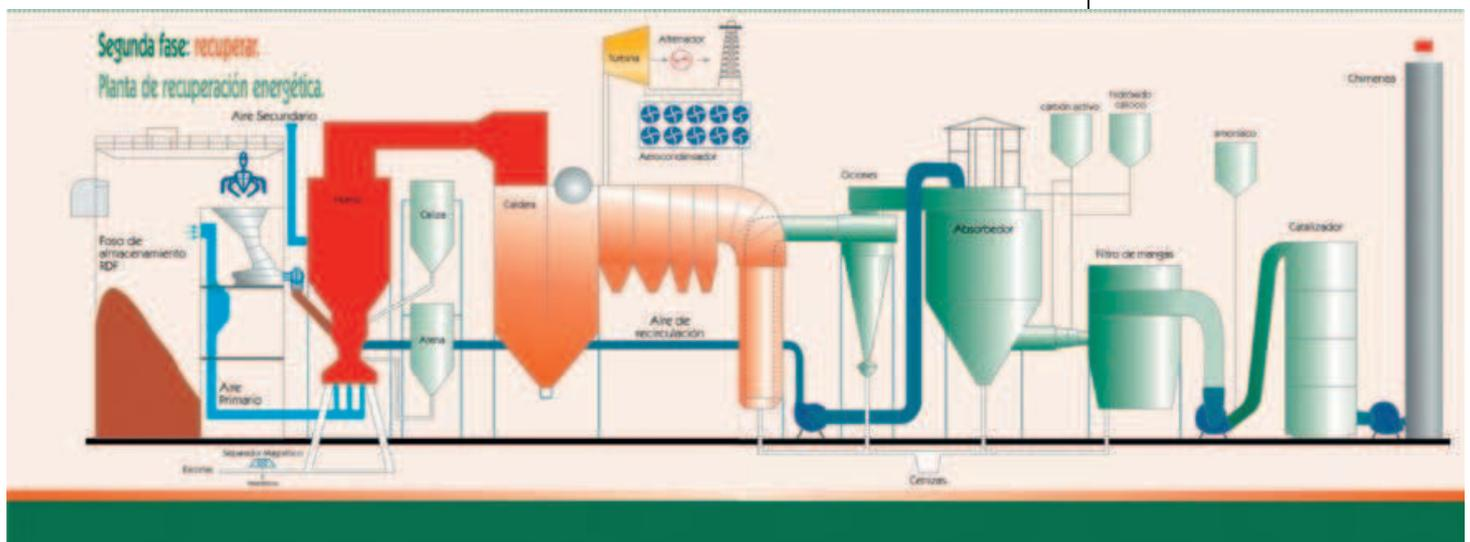
Figura 4.2. Esquema de la Planta de Recuperación Energética.
