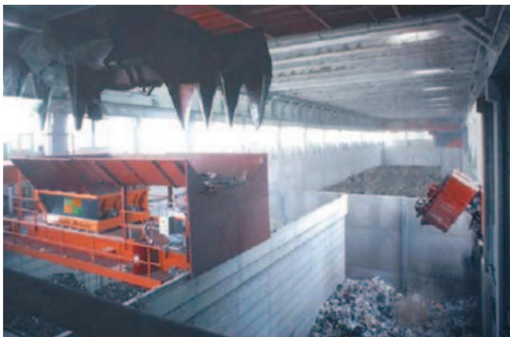
**Foto 2.3.** Vista del interior: descarga, trituración y zona de biosecado.
