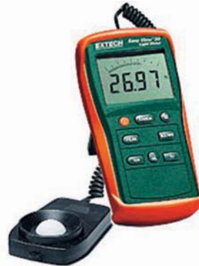
Foto 5.4. Luxómetro. (Fuente: Extech).
