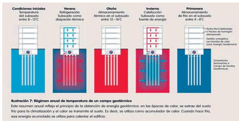
**Figura A1.2.** Régimen anual de temperaturas de un campo geotérmico (Fuente: Zent-Frenger).
