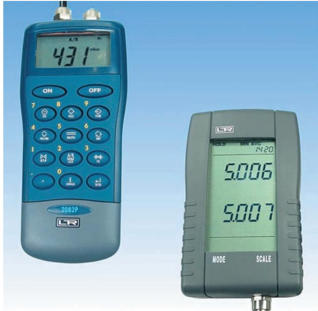
Foto 5.11. Manómetros digitales (Fuente: Leitenberger).
