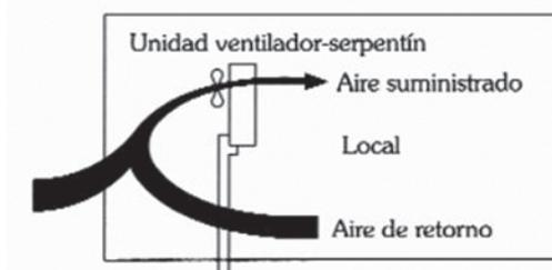
**Figura A2.5.** Esquema de sistema todo agua (Fuente: Geoter).
