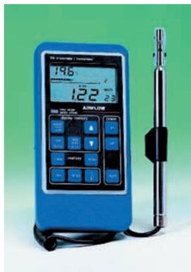
**Foto 5.9.** Anemómetro (Fuente: BSRIA Instruments).
