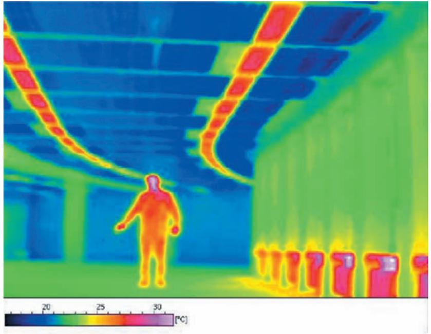
**Figura A2.2.** Termografía donde se puede apreciar el efecto térmico de los elementos de climatización (Fuente: Geoter).
