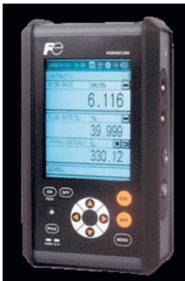
**Foto 5.10.** Caudalímetro ultrasónico portátil (Fuente: Fuji Electric Instruments).
