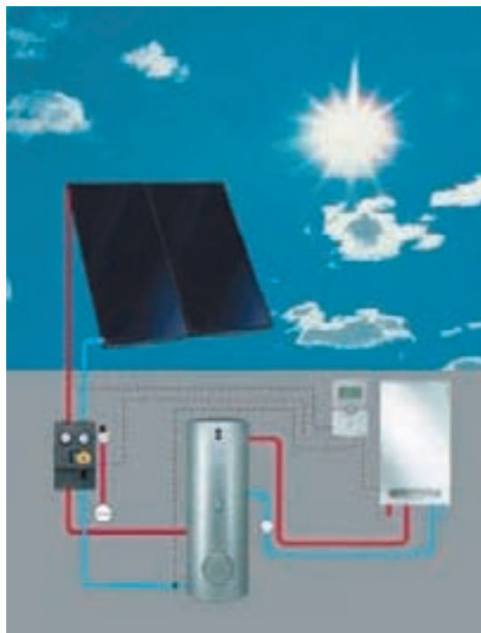
Figura 1. Componentes de una instalación solar.
