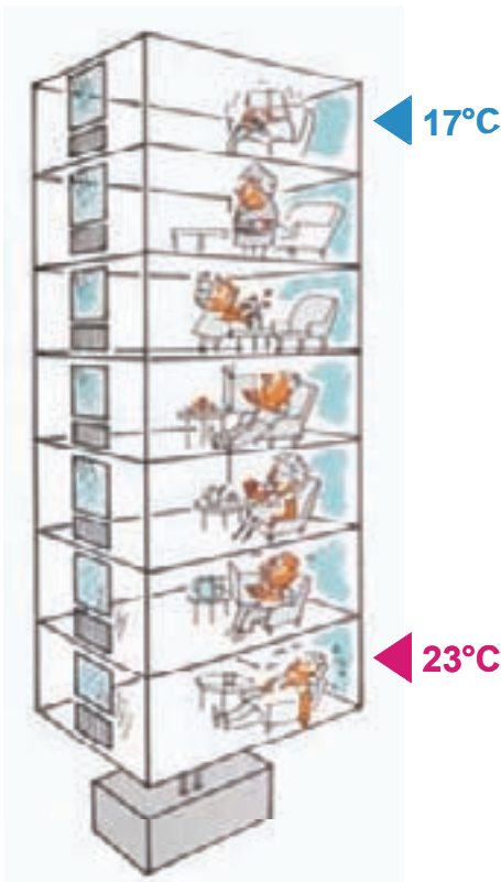
Figura 2. Sistema de calefacción con desequilibrio hidráulico. Los usuarios desfavorecidos se "huelan" mientras que los que reciben sobrecaudales se "asan", por el exceso de emisión de sus terminales.
