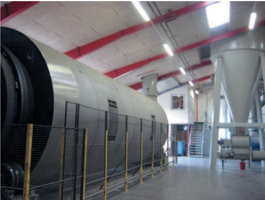
**Foto 12.** Secadero trommel (izquierda) en una planta de granulación con secadero de trommel. A la derecha se puede ver el ciclón de extracción producto seco.
