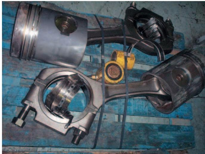
**Foto 1.** Conjuntos pistón-biela, durante una reparación. El pistón inferior presenta marcas de gripado muy acusadas. La avería produjo además la rotura de cojinetes. Fuente: Archivo Renovetec.
