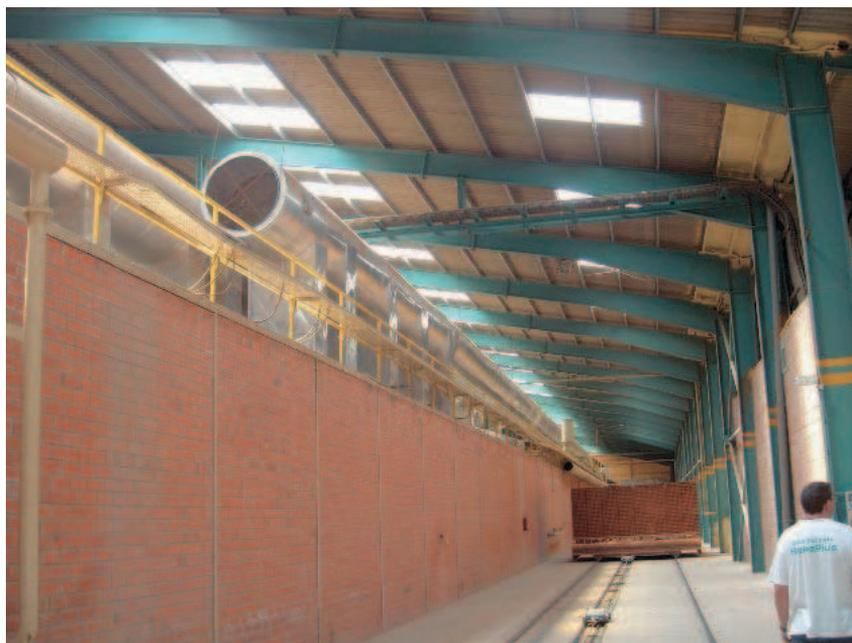
Foto 7. Secadero de una fábrica de ladrillo rojo.
