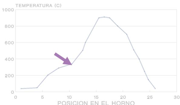
**Figura 15.** Evolución de temperaturas a lo largo de un horno túnel para la fabricación de ladrillo.
