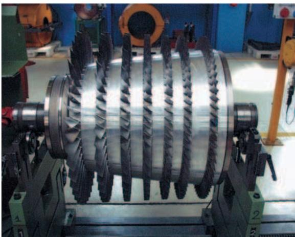
**Foto 4.** Compresor de una turbina aeroderivada durante una reparación.
