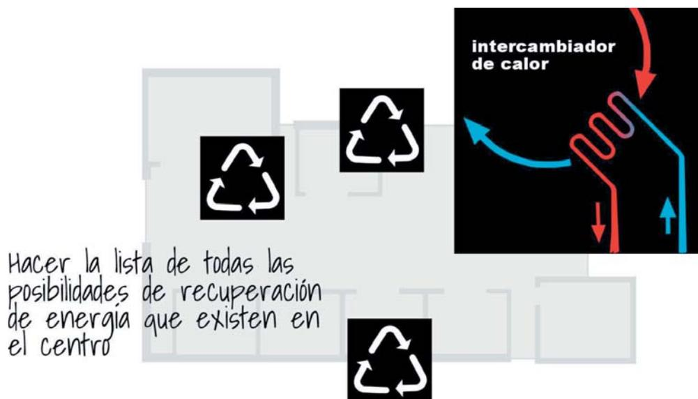
Las máquinas que proporcionan energía útil para climatización e incluso iluminación tienen notables pérdidas de energía térmica, que generalmente se disipa en el ambiente sin provecho. Instalar sistemas de «reciclaje» de esta energía significa multiplicar la eficiencia energética del sistema.
