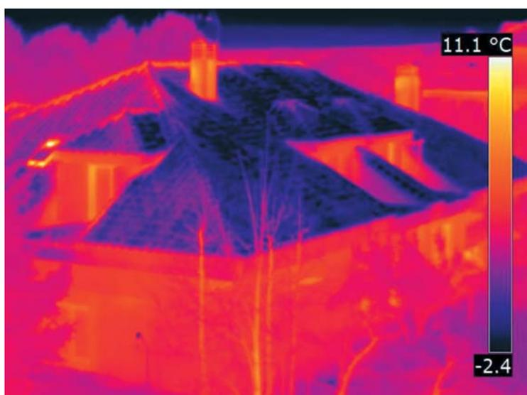
Figura 12. Imagen infrarroja del exterior de una vivienda.
