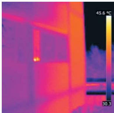
En la imagen se observan los puentes térmicos en fachada sureste en la unión de la estructura del edificio con el cerramiento, donde se producen pérdidas térmicas como revela el termograma.
