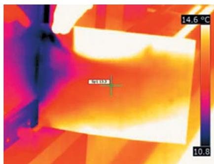
Figura 3. Termograma durante un test Blower Door.
