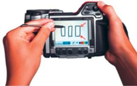
Figura 14. Anotaciones con puntero. Fuente: Flir Systems.
