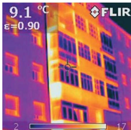
Figura 2. Edificio parcialmente aislado.
