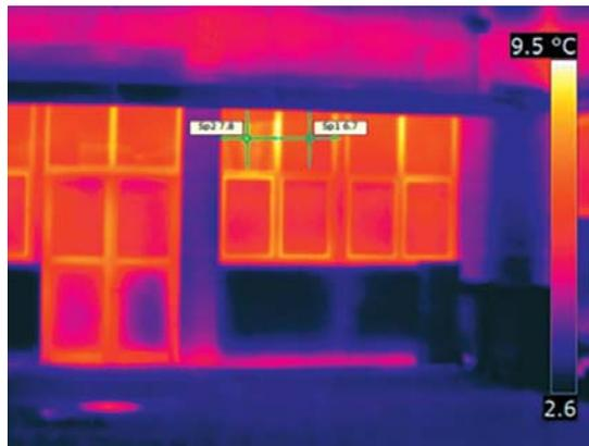
**Figura 3.** Imagen infrarroja de las ventanas de una fachada.
