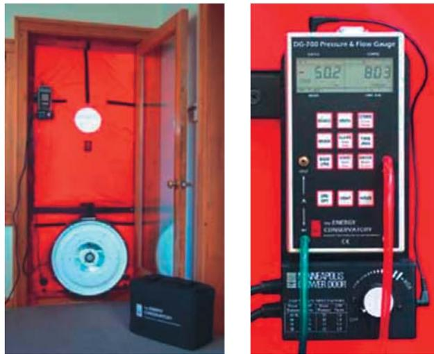
Figura 1. Ejemplo de Blower Door y controlador.
