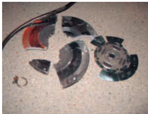
Foto 3. a) Destrucción catastrófica accidental en un volante de inercia de acero. Fuente: [ http://img152.imageshack.us/img152/1545/40100813.png ].
