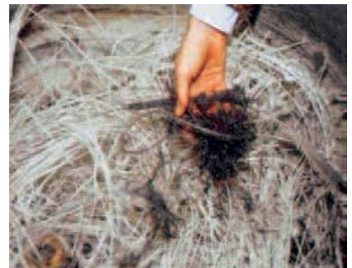
Foto 3. b) Destrucción catastrófica accidental en un volante de inercia de fibras compuestas. Fuente: [ http://www.aspes.ch/image/debris1.jpg ].
